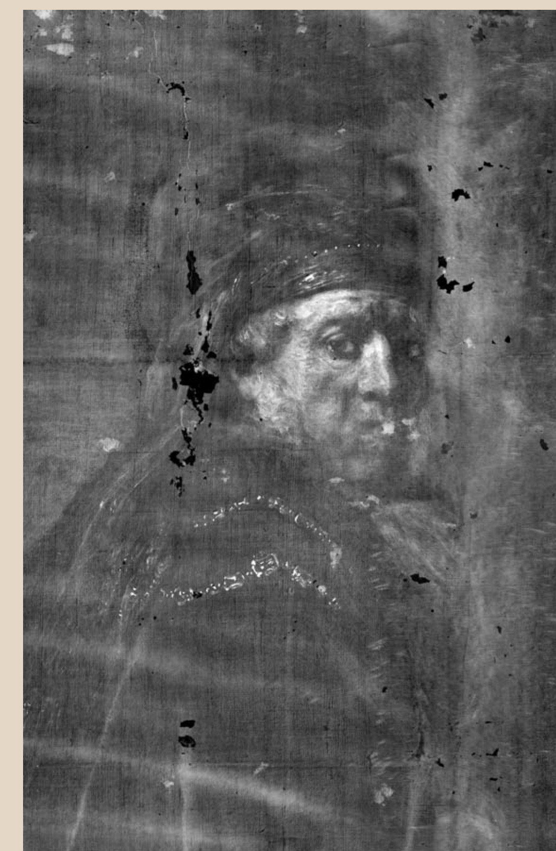
3. Na rentgenovém snímku jsou viditelné jednotlivé defekty tmelené křídovým tmelem. Ty jsou zejména černé barvy, ale objevují se i ve světlém tónu. In the X-ray photograph one can see the individual defects filled with chalk filler. These are mainly black but also appear in a light tone.
